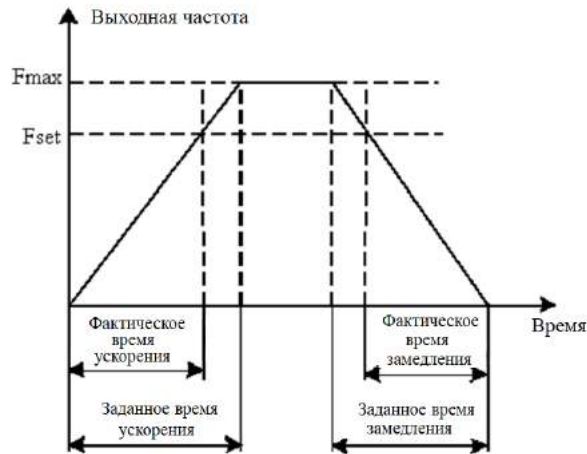
Рис. 6-2 Схема времени ускорения/замедления
