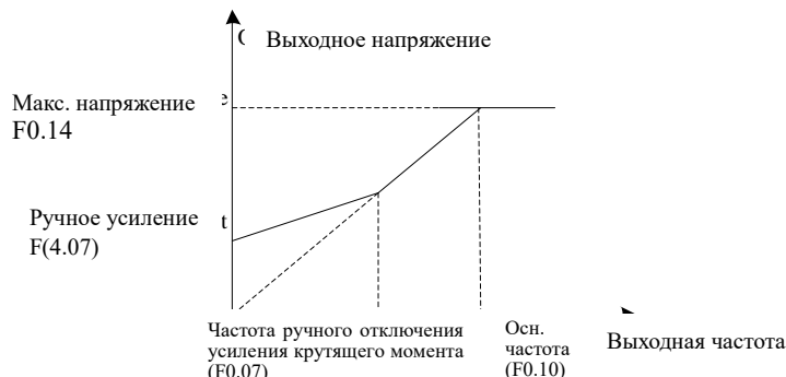
Рис.6-10 Схема усиления крутящего момента
