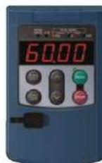
Пульт управления можно отсоединить от преобразователя и подсоединить к персональному компьютеру с установленным профильным программным обеспечением (через USB-порт), таким образом, сохраненные данные можно посмотреть не только на месте установки, но и в офисе.
